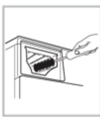
3. Nettoyez l'intérieur du logement du bac à détergent avec une vieille brosse à dents par exemple.
